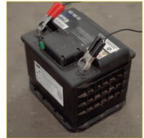
ALIMENTAÇÃO BATERIA DE 12V
