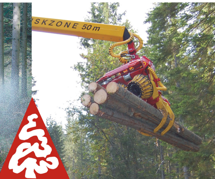
O sistema de rolos dobráveis para cima permite uma carga totalmente operacional e com giro infinito do rotator.
