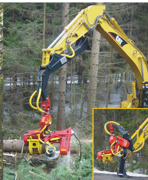
Acessório opcional para montagem em carregadeiras, serve para apoio e também para arrancar tocos, desmanchar curvas de nível etc...
