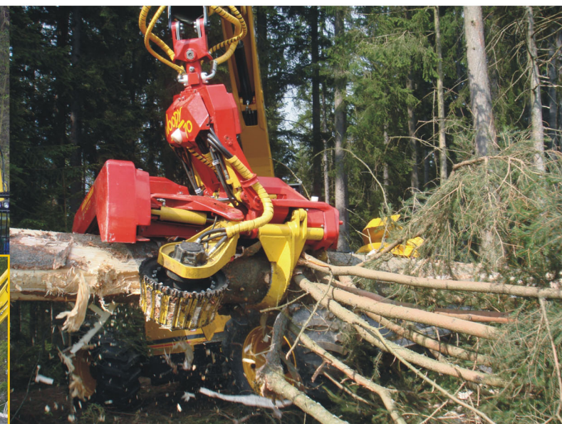
O WOODY 70 é construído para madeiras pesadas e com grandes galhos. Devido aos dois motores sobre os cilindros de alimentação do WOODY ele trabalha com grande poder sobre toras pesadas e em madeiras menores ele trabalha com maior velocidade.
