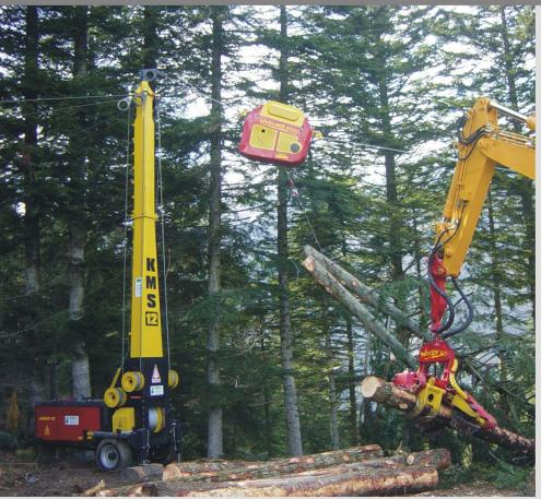
O cabo aéreo KMS 12 U é montado em um tandem e totalmente acionado por controle remoto tanto na montagem quanto na operação. Para aumentar a produtividade, o trabalho do carro transportador é totalmente automático. Outro aspecto é que o trabalho com o controle remoto traz um alto grau de segurança e conforto, com isto um incremento excepcional na produtividade da colheita.
