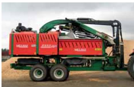
**WT 10 DLK.** WT 10 sob rodas com motor diesel CAT C18 700 HP, estilhaçador com plataforma giratória.
