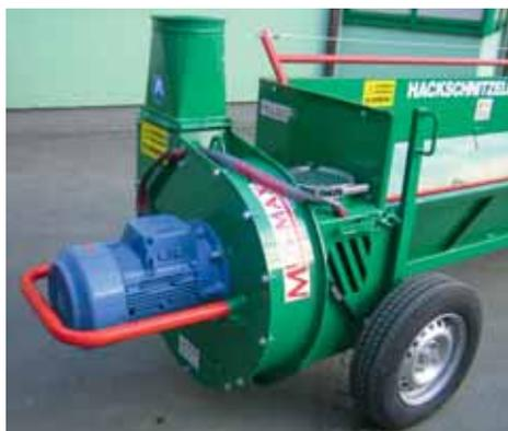
**DEPOSITOR DE ASPIRAÇÃO:** Um dispositivo ideal para sistemas de aquecimento mais pequenos. O depósitor também pode ser usado para reabastecer estilhas a partir do armazém de estilha à extremidade de descarga. Disponível nas seguintes versões: depósitor de aspiração com motor eléctrico (7,5-18,5 kW) ou tractor (pode ser usado com uma tremonha ou uma mangueira de sucção a partir da abertura basculante ou do solo).
