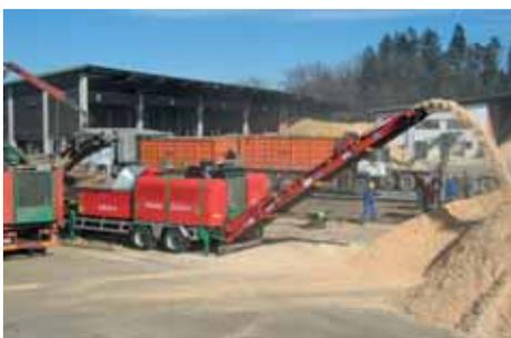
**WT 10 DLB.** Máquina transportadora de descarga longitudinal (descarga por tapete)
