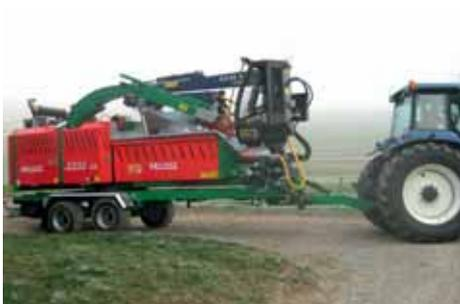
**WT 10** sob rodas com motor diesel John Deere 600 HP, estilhaçador com plataforma giratória.
