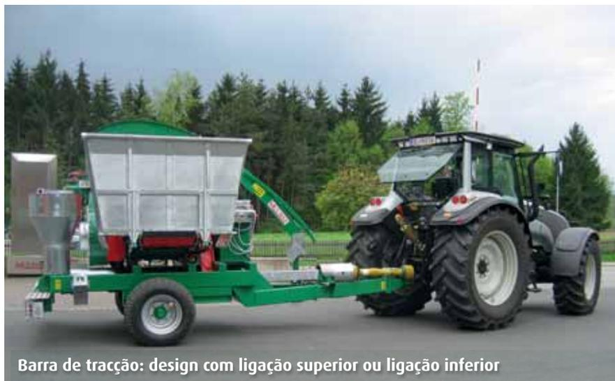
Barra de tracção: design com ligação superior ou ligação inferior
